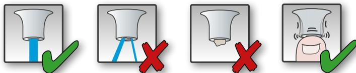
Ebenso empfehlen wir eine bedarfsgerechte Innenentkalkung der Kopfbrause. Hierfür sollte die Kopfbrause komplett vom Wandhalter abmontiert werden (**bitte die Brause selbst nicht öffnen**). Geben Sie in den Anschluss der Kopfbrause unter Berücksichtigung unserer Pflegehinweise einen handelsüblichen Sanitär-entkalker. Nach ausreichender Einwirkzeit und Montage ist eine Kaltwasserspülung notwendig um innere Produkthanftungen auszuschließen.
